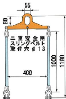
■ALCパネル用吊クランプ・押出成型版用吊クランプ
